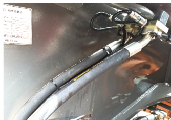
软管下部接口安装传感器
