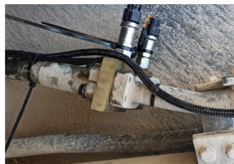
软管上部接口安装传感器
